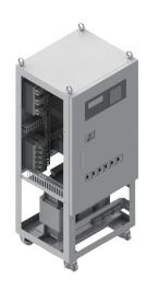
해당제품은 상시에 직류전원부하에 전원공급과 직류배터리에 부동충전 및 균등충전을 하는 장치입니다. 정전이 발생됐을 때 부하에 전원공급을 우선으로 충전된 배터리의 전원을 사용하며, 전원 용량 변화에 따른 저전압 경고 알람을 제공합니다.
