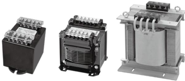
단상단권형으로 입력과 출력 전압이 한권선으로 전압탭을 인출하여 크기가 작고 가격이 저렴한 반면 사용이 제한되어 Lamp, Heater, Motor, Fan부하 등 단순 부하에 사용되나 콘트를 제어 위치제어 PLC, 각종 Noise에 영향을 받는 제품 사용시에는 오동작 우려가 있으니 신중하게 고려 하시기 바랍니다.
