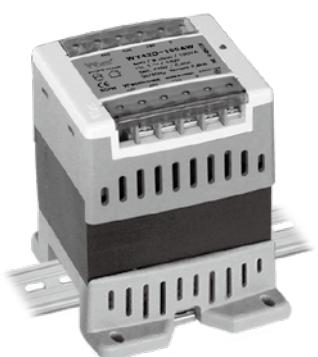
단상단권형으로 입력과 출력 전압이 한권선으로 전압탭을 인출하여 크기가 작고 가격이 저렴한 반면 사용이 제한되어 Lamp, Heater, Motor, Fan부하 등 단순 부하에 사용되나 콘트롤 제어 위치제어 PLC, 각종 Noise에 영향을 받는 제품 사용시에는 오동작 우려가 있으니 신중하게 고려 하시기 바랍니다. AC 입력 전압 인가시 전원 표시 LED가 동작하여 소비자의 안정성을 고려한 제품입니다. DIN Rail 전용(Bolt 취부 겸용)으로 DIN Rail에 손쉽게 장착 할 수 있습니다.
