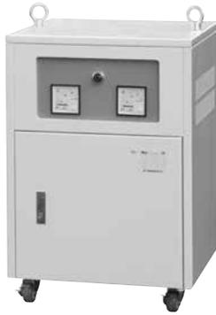
삼상, 복권형으로 일반 Dry Type으로 Casing화 하여 전면에는 Lamp V-M, A-M, NFB 등을 부착하였으며 작업자의 작업성을 고려하여 뒷면은 Door 식으로 하여 단자대 (Terminal Block)를 부착하여 작업의 편리성을 증대 하였으며 운반이 용이하도록 Panel에는 운반용 바퀴로 제작 하였습니다.
