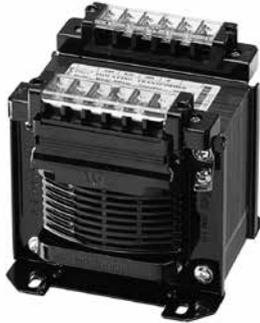
단상 복권형으로 입력은 AC 380V,440V 이고 출력은 AC 110V,220V, AC12V, 24V로 분리하여 1곳에서 2곳의 전원이 필요한 장소에서 용이하며 AC 입력전원 인가시 전원 표시 LED가 동작하여 소비자의 안정성을 고려한 제품입니다.
