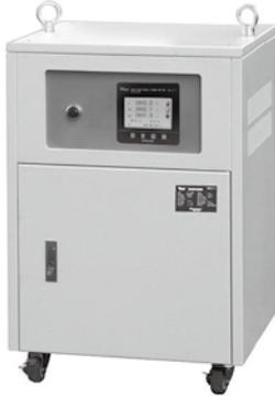
단상, 복권형으로 일반 Dry Type으로 Casing화 하여 전면에는 Lamp,계측기, NFB 등을 부착하였으며 기존 전압, 전류만 계측하는 것을 넘어 전력, 전력량, 전력품질, 온도 등 다양한 동작상태를 계측, 지원하며 실시간 데이터를 485통신으로 상위통신망에 접속이 가능합니다. 사용간 발생할수 있는 전기적 이슈에 대하여 최대 8가지 항목중 2개 요소를 선택하여 알람을 받아볼수 있습니다. 뒷면은 Door 식으로 하여 단자대(Terminal Block)를 부착하여 작업의 편리성을 증대하였으며 운반이 용이하도록 Panel에는 운반용 바퀴로 제작하였습니다.
